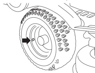
**ВНИМАНИЕ!** Для того чтобы достичь наилучшей производительности, а также избежать повреждения машины, необходимо, чтобы давление в шинах было одинаковым.
