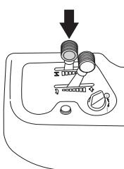
При "холодном" пуске двигателя отведите ручку регулятора назад до упора.
