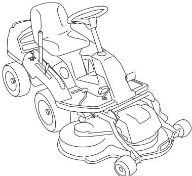
Механический привод двигателя управляется гидростатической трансмиссией, обеспечивающей бесступенчатое изменение скорости с помощью педалей.
