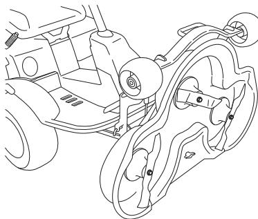
Рабочий узел фиксируется в вертикальном положении автоматически.
