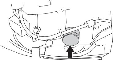
Нанесите на резиновую прокладку нового фильтра небольшое количество нового масла. Смонтируйте масляный фильтр, повернув его по часовой стрелке. Поворачивайте усилием руки, пока резиновая прокладка не будет прилегать. Затяните потом еще на пол оборота.
